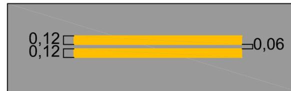
DETALHE DA PINTURA CONTÍNUA DO EIXO DA PISTA
