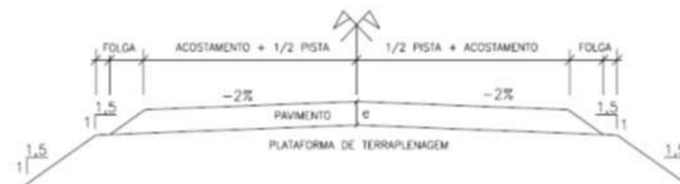
Figura 1: A folga é ocupada pelo talude do pavimento mais a dimensão necessária à perfeita execução do serviço
